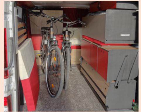
Légère avec l'emploi d'aluminium, la banquette et ses tiroirs-coffres positionnés sur les modules laissent un volume capable d'accueillir deux vélos électriques et un vélo enfant ! Fixations semi-automatiques.
